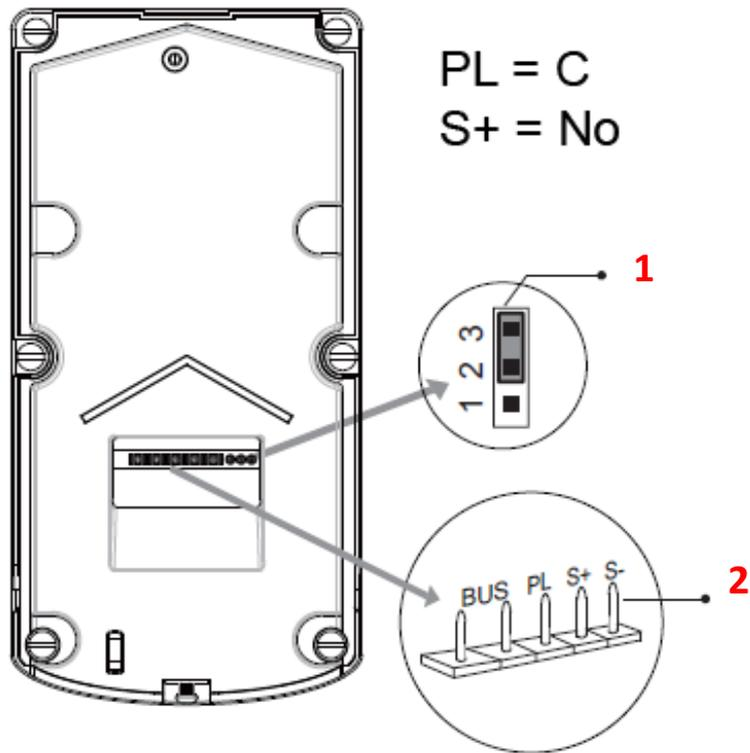
**1 - Dip-switch pour déterminer le type de verrouillage**
