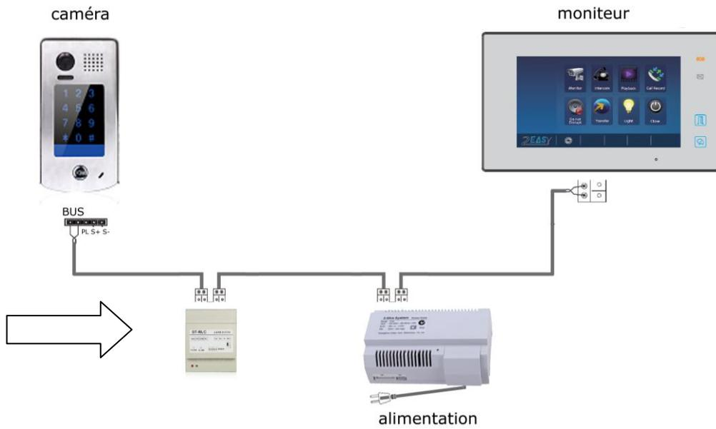
Connecter le KDT-RLC pour commander le 2ème relai (voir la documentation du KDT-RLC avec en sortie une tension ou un contact sec)
