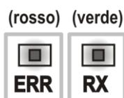
Pendant le fonctionnement normal la led RX indique la puissance du signal radio reçu, la led ERR est éteinte (aucun défaut). Pendant la phase d'installation initiale, les leds RX et ERR clignotent alternativement. Si des défauts sont détectés, la **led ERR et le voyant SCA** font un nombre d'éclats qui indiquent à l'installateur le type de défaut (voir le tableau ci-dessous).
