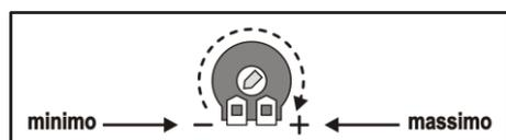
**RF1:** Réglage de la force électronique du moteur M1 de 30% à 100%
