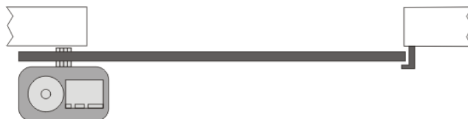
Motore MC3 a sinistra DIP 6 a OFF
