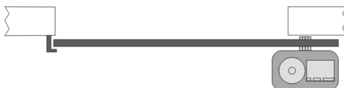
Motore MC3 a destra DIP 6 a ON
