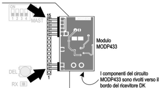
Prétre le maximum d'attention pour une insertion correcte du module. En particulier, le module doit être inséré de sorte que son premier picot corresponde au pin n° 15 (voir sérigraphie) du récepteur DK230.
