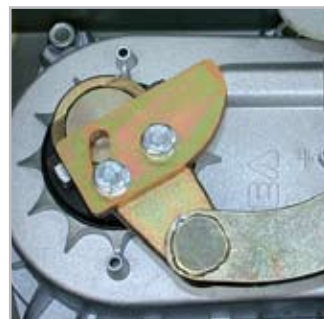
Stops mécaniques réglables dans les deux directions
