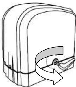
Le moteur étant fixé sur son support, débrayez le manuellement avec la clé 6 pans en la tournant dans le sens inverse des aiguilles d'une montre jusqu'à ce que le pignon tourne avec la clé (environ 5 à 6 tours).
